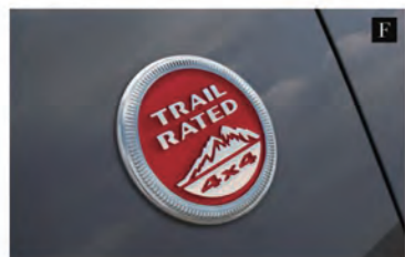
D: 黒レザーシートが映えるクラス感のあるインテリアとコックピット。衝突被害軽減ブレーキ付きで、前面衝突警報や車線逸脱警報をはじめ、新進の安全装備と運転支援装備も充実している E: 黒を基調にレッドステッチを効かせたレザーシートにも、プレミアム感を感じさせる F: 〈ジープ〉の中でも特に優れた4×4性能を持つモデルに与えられたバッジ。最も険しいオフロード性能試験に合格した証でもある
